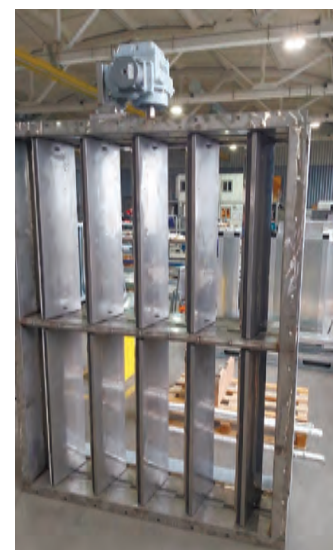
Клапан противопожарный комбинированный модульно-секционный с системой обогрева
