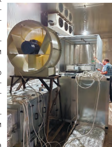
Установка испытания противопожарного клапана в климатической камере
