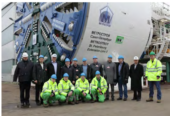
Двухпутный тоннелепроходческий щит на строительстве станции «Южная» Фрунзенского радиуса.
