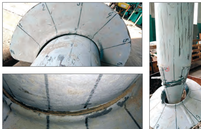
Рис. 4. Отрыв лопасти при испытании на осевое растяжение
