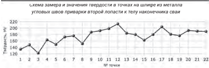
Распределение твердости по точкам сварного соединения
