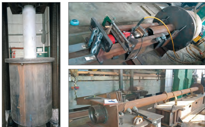
Рис. 3. Этапы проведения испытаний: а — испытание сваи винтовой на сжатие; б — испытание сваи на растяжение; в — испытание сваи винтовой лопастной (СВЛ) на кручение
