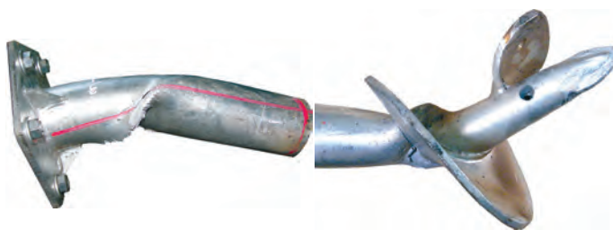
Рис. 5. Деформация сваи при испытании на кручение
