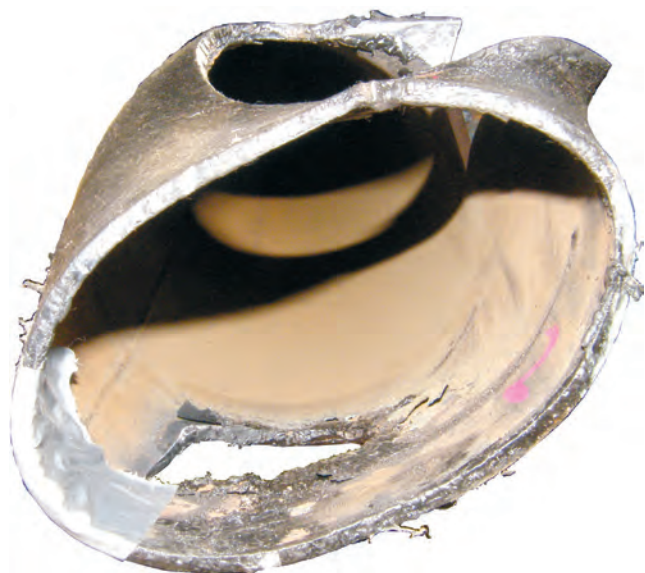
Рис. 6. Разрывы и пластическая деформация технологического отверстия в месте контакта с пальцем, передающим крутящий момент
