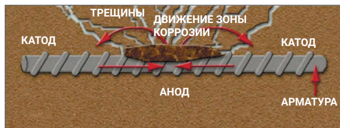
Рис. 1. Коррозия арматуры в бетоне
