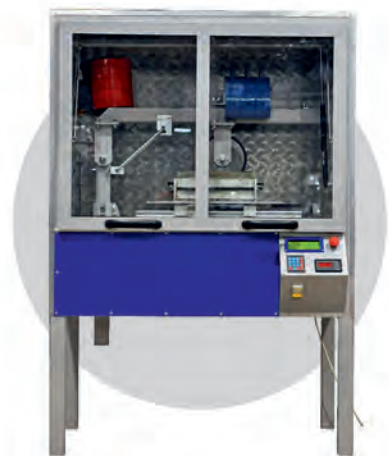
УСТАНОВКА ДЛЯ ИСПЫТАНИЯ НА КОЛЕЕОБРАЗОВАНИЕ УК-1 РДТ
