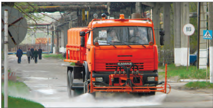
Комплексная дорожная машина КДМ-316 с комплектом поливмоечного оборудования
