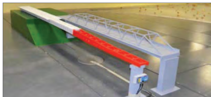
«Танцующий мост» в г. Волгограде: а — общий вид; б — Общий вид полной динамически подобной модели в рабочей части ЛАДТ
