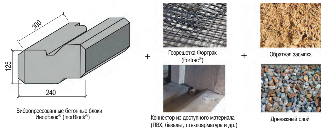
Рис. 1. Компоненты системы «Инорблок»
