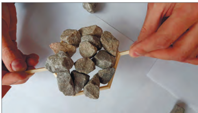
Рис. 2. Заклинка 3D-георешетки с соотношением 1:1 высотой поперечного сечения георешетки 5 мм диаметром 75 мм для фракции щебня 20 мм
