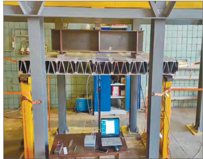
Рис. 5. Стенд для испытания материалов и конструкций пролетных строений и дорожной одежды на усталостную долговечность
