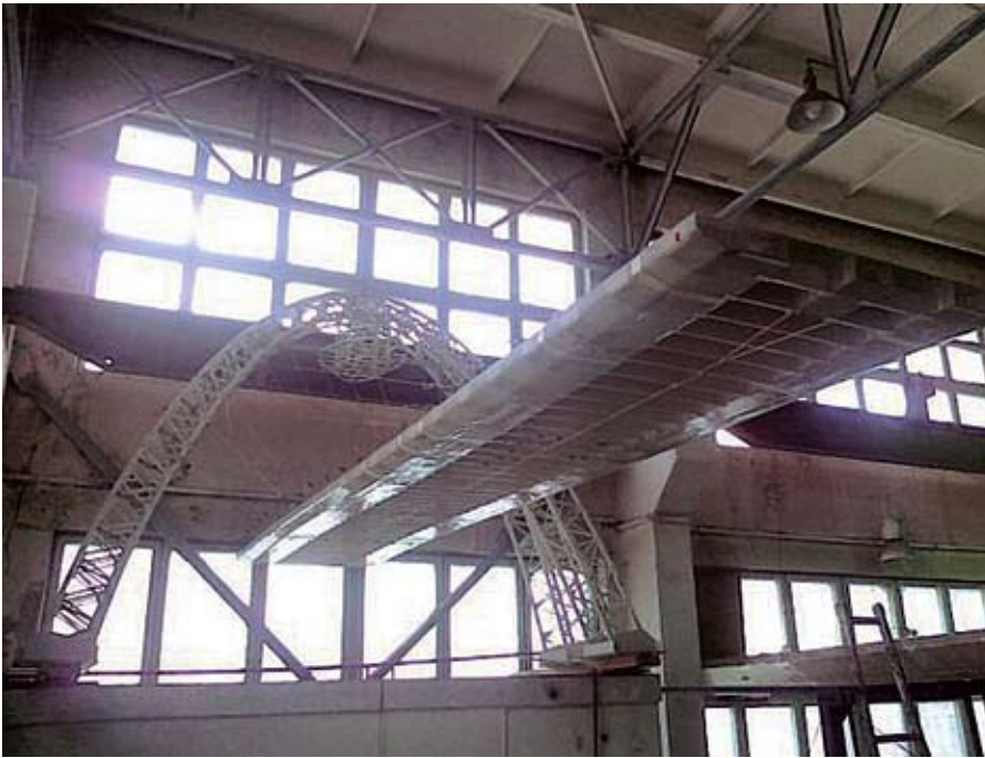
Модель Живописного моста в испытательной лаборатории ОАО «ЦНИИС»
