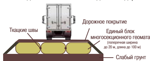
Укладка блочных геоматов вдоль оси дороги
