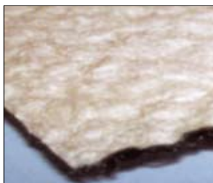
Виды геоматов: а – волоконный мат; б – волоконный мат, армированный геосеткой; в – трехслойный дренажный мат (композит) с волоконным сердечником; г – 3-слойный дренажный мат (композит) с жестким сердечником из экструдированной георешетки (сверху)
