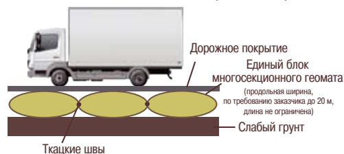
Укладка блочных геоматов поперек оси дороги
