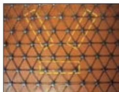
Виды георешеток: а – тянутая с одномерными ячейками; б – тянутая или экструзионная с двумерными ячейками; в – тянутая гексагональная
