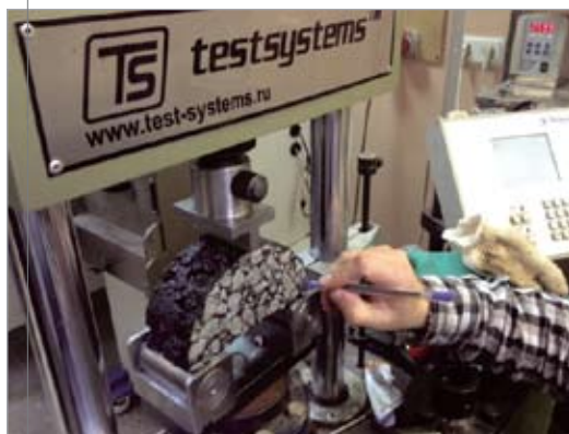
Рис. 3. Схема испытания на трещиностойкость полуцилиндрических образцов
