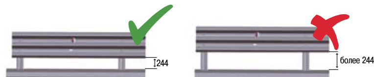
Рис. 3. Безопасное расположение балки дорожного ограждения
