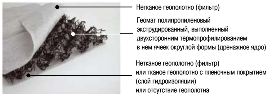
Рис. 1. Дренажный геокомпозит «Макдрейн® М»
