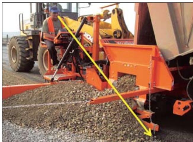
Рис. 2. Укладчик с местом для оператора
