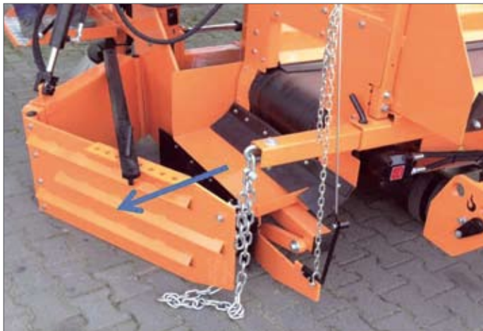
Рис. 3. Укладчик с уникальным выдвижным корректирующим столом
