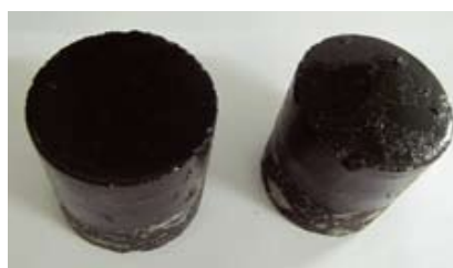
Рис. 7. Образцы для испытания на истираемость резиновыми шинами на круге ЛКИ-3, обработанные пропиткой ASP с торцевой стороны
