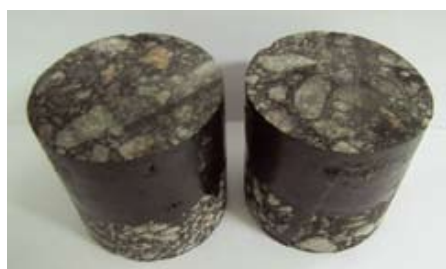
Рис. 9. Общий вид образцов, обработанных пропиткой ASP, после испытания на истираемость на круге ЛКИ-3
