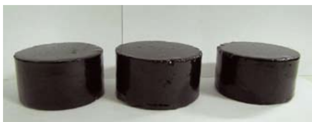
Рис. 6. Образцы для испытания на износ шипами по методике АШМ, покрытые пропиточным составом ASP со всех сторон
