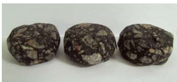
Рис. 8. Общий вид образцов (пропитка ASP) после испытания на износ в шаровой мельнице
