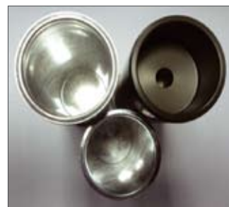
Рис. 3. Конфигурация: соосные элементы, при вращении вызывающие сдвиговую деформацию образца
