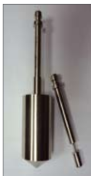
Рис. 3. Конфигурация: соосные элементы, при вращении вызывающие сдвиговую деформацию образца
