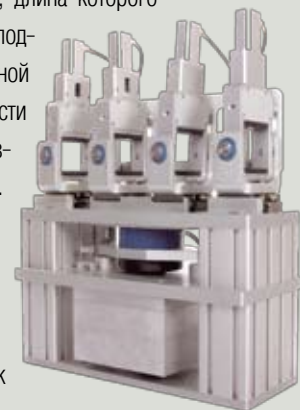
CRT-SA4PT-BB-Серво-пневматическая система для определения усталости при четырехточечном изгибе аб образцов-балочек
