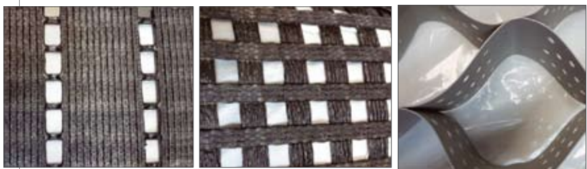
Рис. 2. Классификация ГСМ по распределению прочностных характеристик, слева направо: одноосно-, двuosно-, многоосно-ориентированный
