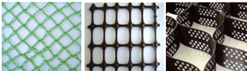
Рис. 1. Слева направо: геосетка, георешетка, геосотовый материал
