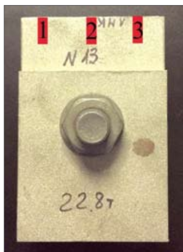
Рис. 1. Места замеров шероховатости
