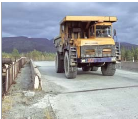
Рис. 2. Пропуск автодорожной нагрузки по сооружениям ОАО «Апатит». БелАЗ-7547 в загрузочном состоянии с давлением на заднюю ось 520кН
