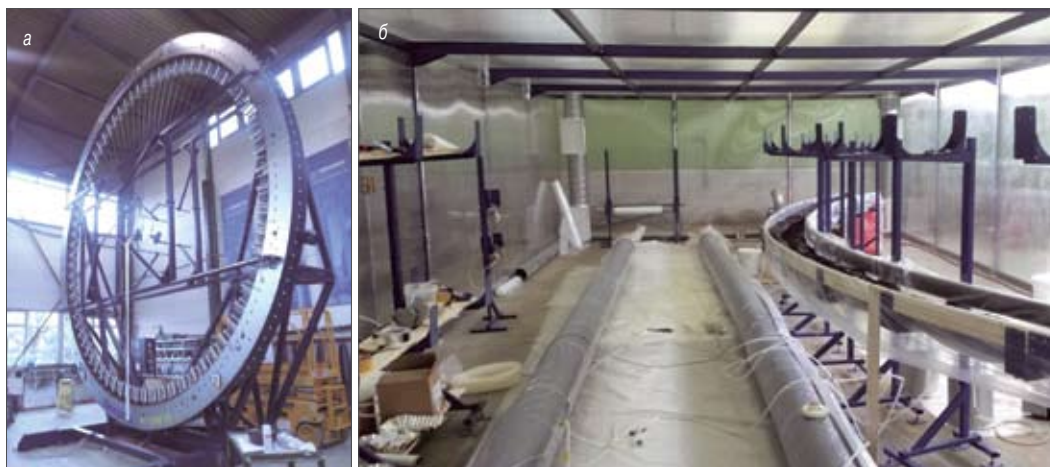
Рис. 1. Этапы изготовления углепластиковой оболочки: а – устройство для изготовления плетеного рукава; б – изготовление углепластиковой оболочки
