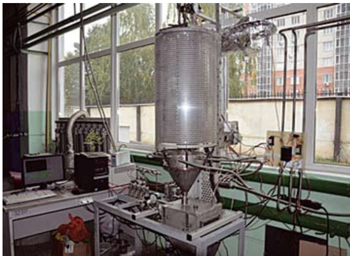
Реактор непрерывного действия для выпуска углеродных нанотрубок в промышленных масштабах («НаноТехЦентр», Тамбов)
