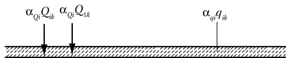
Рис. 1. Продольная схема нормативной западноевропейской нагрузки LM1 (Eurocode 1 EN 1991-2:2003: The European standards for structures, 2003)
