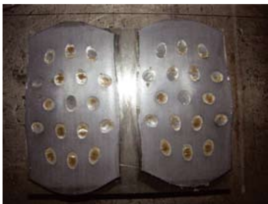
Рис. 4. Вид образцов с лунками и смазкой после статического нагружения
