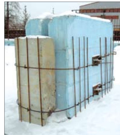
Рис. 10. Макет усиления опоры высокопрочной прядевой арматурой
