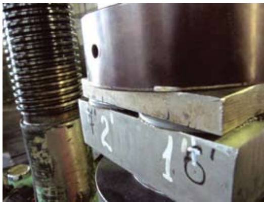
Рис. 3. Испытание модифицированного фторопласта на сжатие
