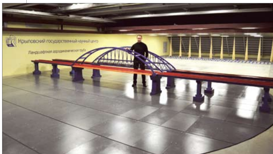
Рис. 6. Модель арок Крымского моста в рабочей части Ландшафтной аэродинамической трубы
