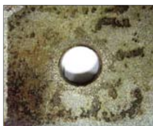
Рис. 5. Контактные поверхности образцов без покрытия после ускоренных климатических испытаний в течение 105 циклов (15 лет)
