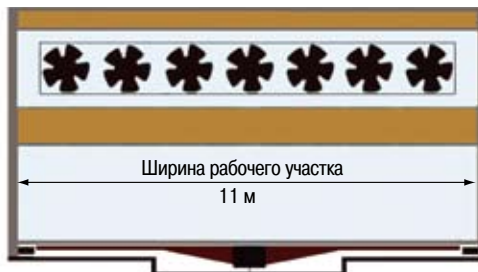
Рис. 3. Поперечный разрез Ландшафтной аэродинамической трубы
