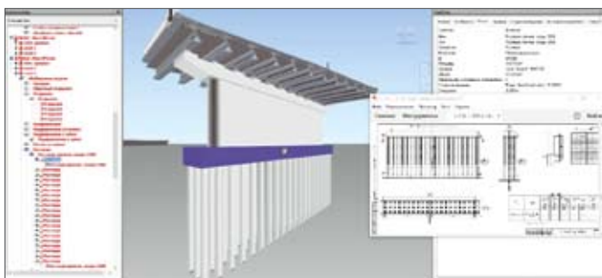
Графическое представление модели опоры мостового перехода с атрибутивным наполнением и привязанным листом чертежа ростверка опоры («Обход г. Барнаул»)
