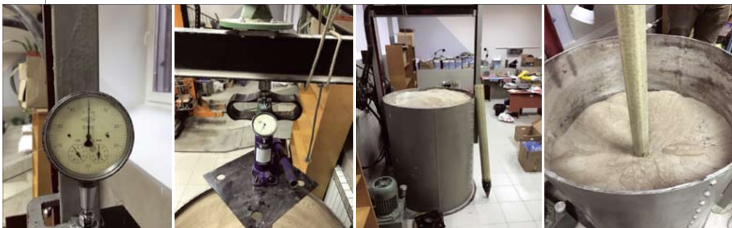
Рис. 1. Свая, погруженная в ЦПС
