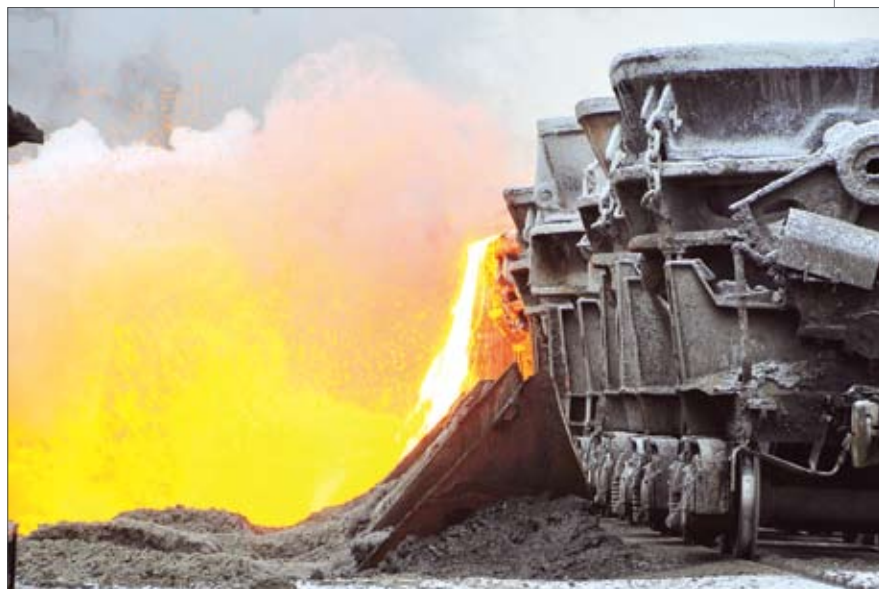
Розлив шлакового расплава на стадии охлаждения и грануляции
