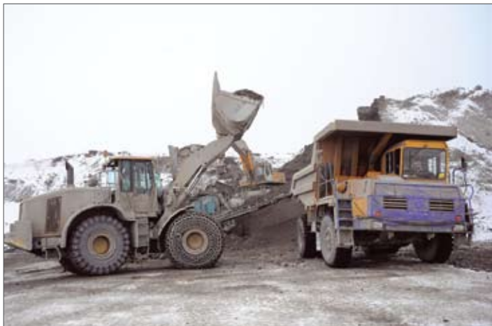
Погрузка и перевозки доменного гранулированного шлака требуют серьезной техники
