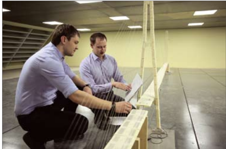
Рис. 6. Проведение тестовых сравнительных испытаний модели моста на остров Русский в Ландшафтной аэродинамической трубе
