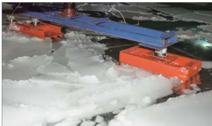
Рис. 8. Экспериментальное определение ледовых нагрузок на опоры Крымского моста в ледовом бассейне Крыловского центра
