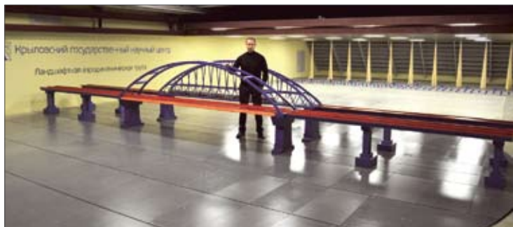
Рис. 7. Модель арок Крымского моста в Ландшафтной аэродинамической трубе
