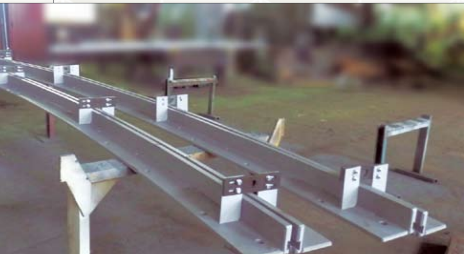
Деформационные швы, криволинейные в плане (ООО «Стройкомплекс-5»)
