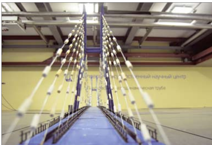
Рис. 3, 4. Исследования упругоподобной модели вантового моста для заказчика из Европы
