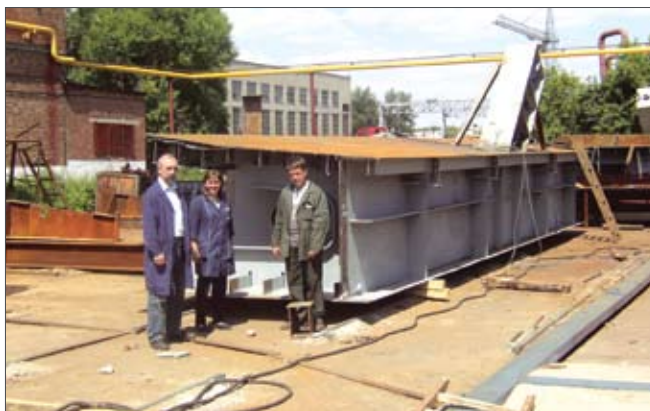
Приемка старшим мостовым инспектором В. Г. Хлапониным узла крепления вант пролетного строения для строительства КАД в Санкт-Петербурге
