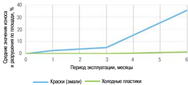
Рис. 10. Динамика изменения средних значений износа и разрушения контрольных линий по типам материалов на участке Р-254 с цементобетонным покрытием в 2010 году
