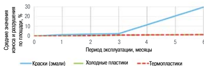
Рис. 8. Динамика изменения средних значений износа и разрушения контрольных линий по типам материалов на участке Р-254 с асфальтобетонным покрытием в 2010 году
