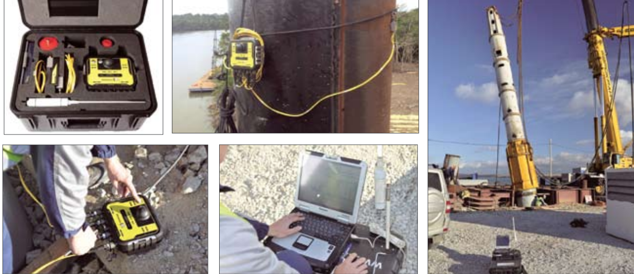
Рис. 3. Система мониторинга свай PDR
