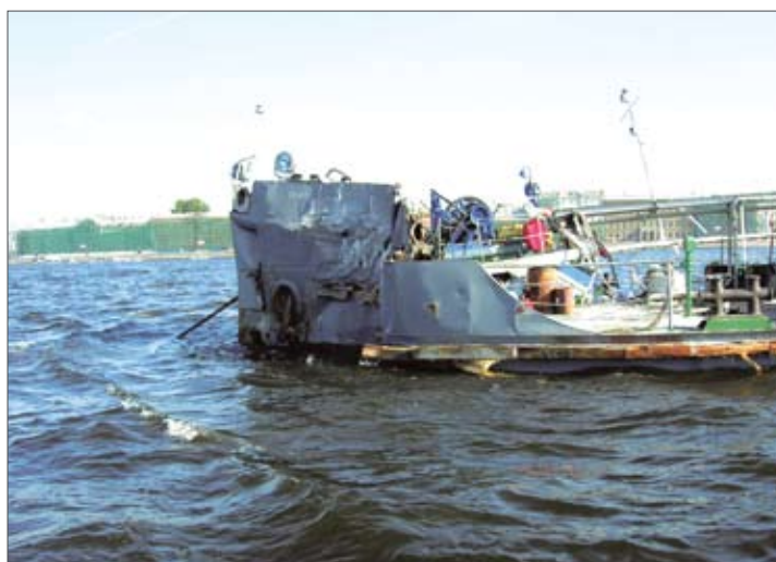
Рис. 3. Судно после навала на опору Троицкого моста
