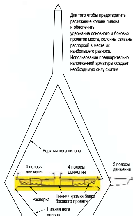
Рис. 10. Конструкция пилона моста ( http://www.concreteconstruction.net )
