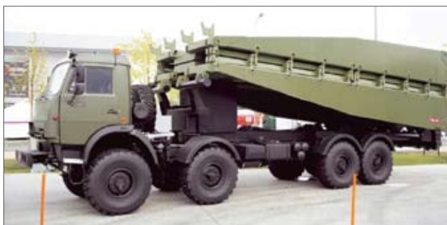
Рис. 6. Опытный образец мобильного композитного моста ТММ-7
