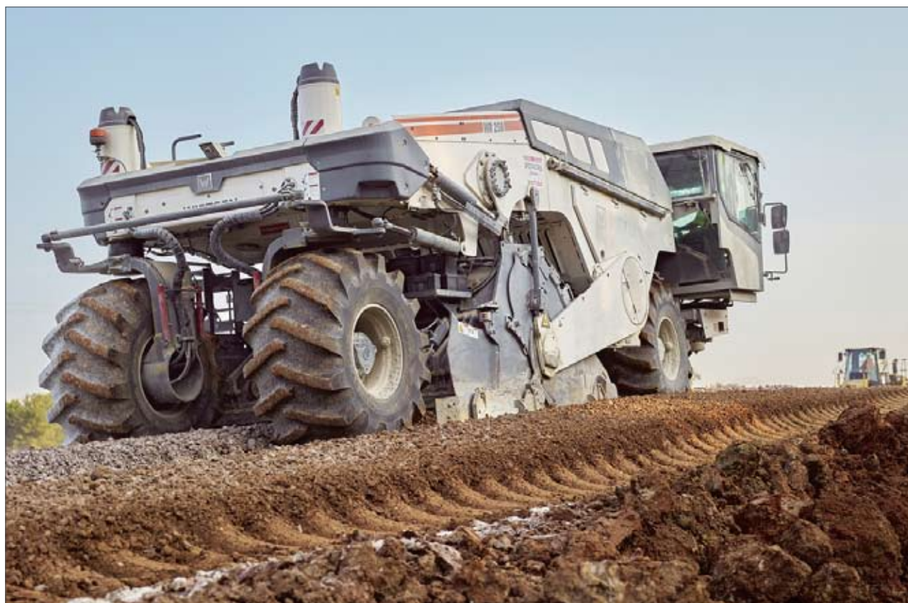
Высокая несущая способность для въезда на трассу Interstate 69: при стабилизации грунта в штате Индиана машина Wirtgen WR 250 продемонстрировала первоклассный результат
