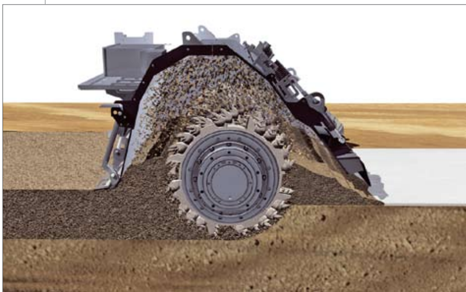
Стабилизация на грани совершенства: насыпанное вяжущее равномерно перемешивается с грунтом с помощью мощного фрезерно-смесительного ротора стабилизатора WR 250
