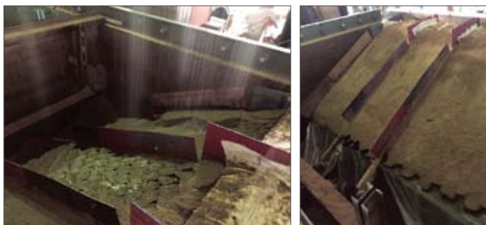
Рис. 2. Натурная модель откоса для определения эффективности удержания заполнителя-песка георешетками при воздействии потока воды
