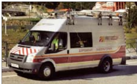
Определение продольной ровности покрытий дорог по международной методике IRI
