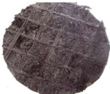
Рис. 1. Общий вид стеклянной геосетки в образце-кjerne, отобранном из покрытия, после четырех лет эксплуатации (просп. Мира, г. Могилев)
