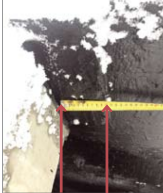
Рис. 6. Положение стенки после смещения открылка (10 см)
