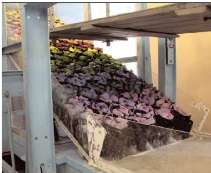
Рис. 1. Гидравлическая модель для определения эффективности удержания заполнителя-щебня при воздействии потока воды
