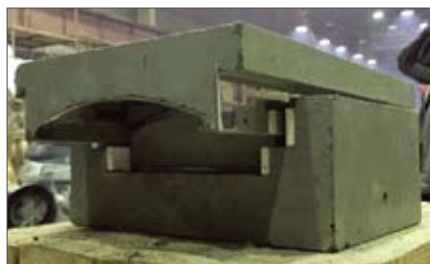
Рис. 3. Линейно-подвижная опорная часть из сверхвысокопрочного сталефибробетона с нагрузкой 100 тс и перемещением на +/- 100 мм ФБОЧ-ЛП-100+/-100
