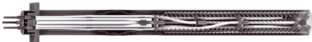
Рис. 4. Извлекаемый грунтовый анкер на обжимных втулках
