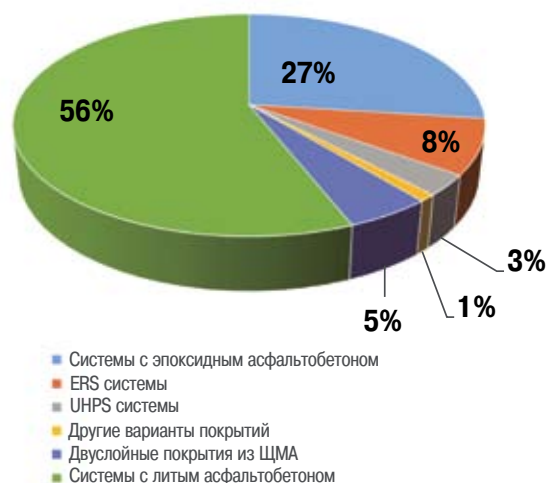
Рис. 1. Распределение применяемых систем покрытий в дорожно-мостовой индустрии Китая
