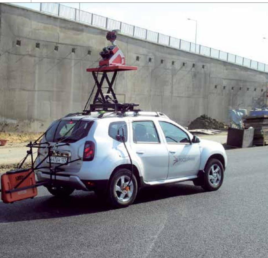
Рис. 1. Дорожная лаборатория ФАУ «РосдорНИИ» с георадаром «ОКО-3» и рупорным антенным блоком «АБ-1000Р»
