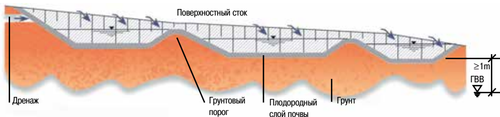
Рис. 2. Схема удаления поверхностного стока в кювет, обустроенный порогами
