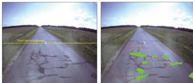
Рис. 2. Автоматическая регистрация дефектов покрытия
