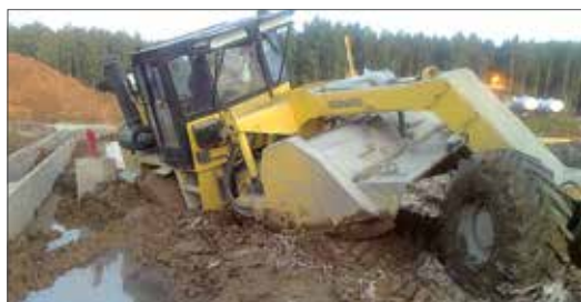
Увязнувший ресайклер на участке с переувлажненным грунтом
