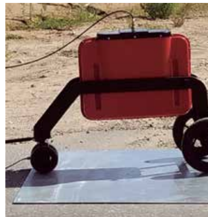
Калибровка георадара над металлическим листом
