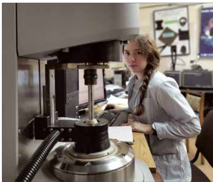
Рис. 2. Испытания вяжущих на реометре динамического сдвига (DSR) в лаборатории физико-химии высокодисперсных материалов ФИЦ ХФ РАН
