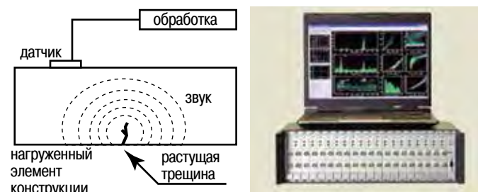
Рис. 5. Схема методики акустической эмиссии и прибор для исследований сигналов АЭ
