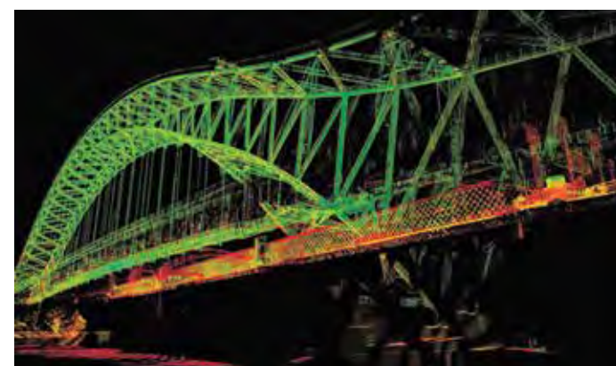
Рис. 4. Эюра «облака» точек в результате лазерного сканирования моста «Красные дракон» в Ханты-Мансийске
