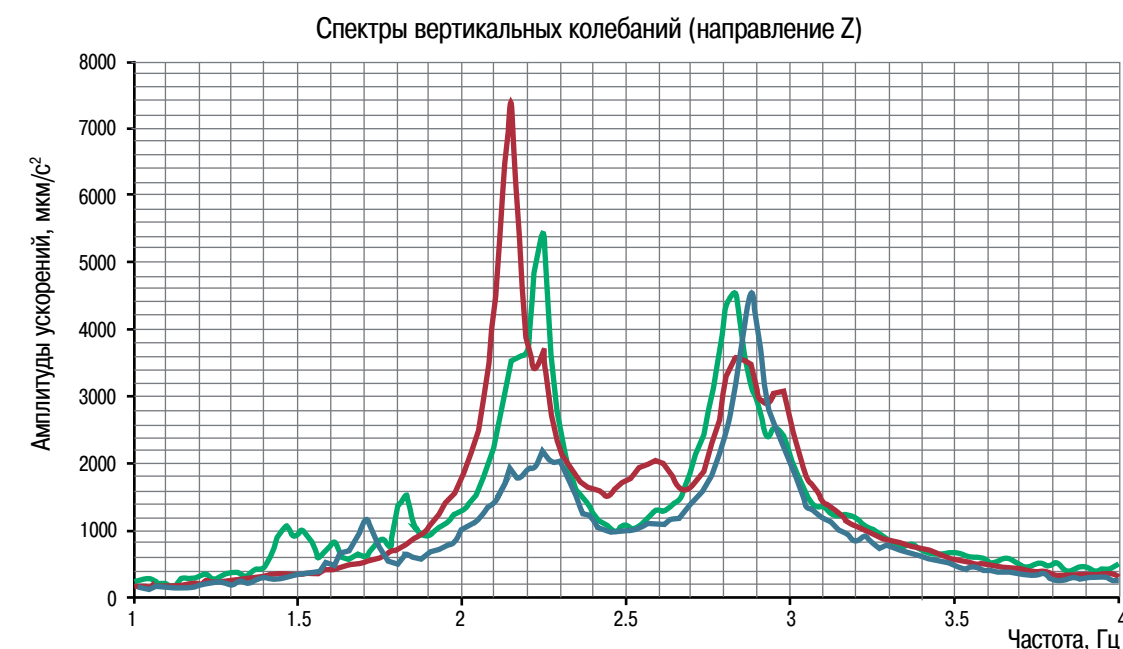
Рис. 1. Спектр ускорений колебаний пролетных строений сталежелезобетонного моста
