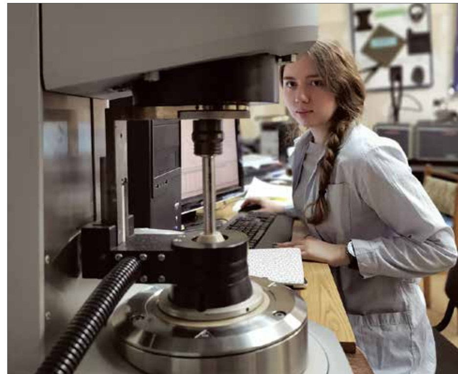
Рис. 2. Испытания вяжущих на реометре динамического сдвига (DSR) в лаборатории физико-химии высокодисперсных материалов ФИЦ ХФ РАН
