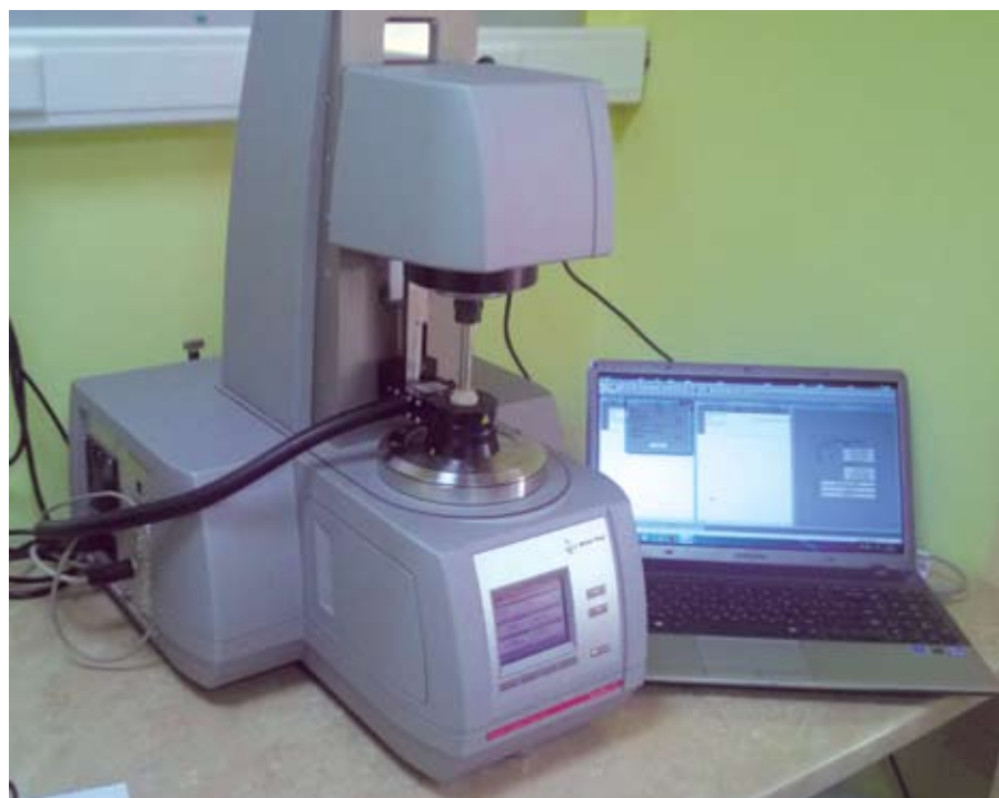
Рис. 5. Реометр динамического сдвига для определения вязкоупругих характеристик образцов по AASHTO T315
