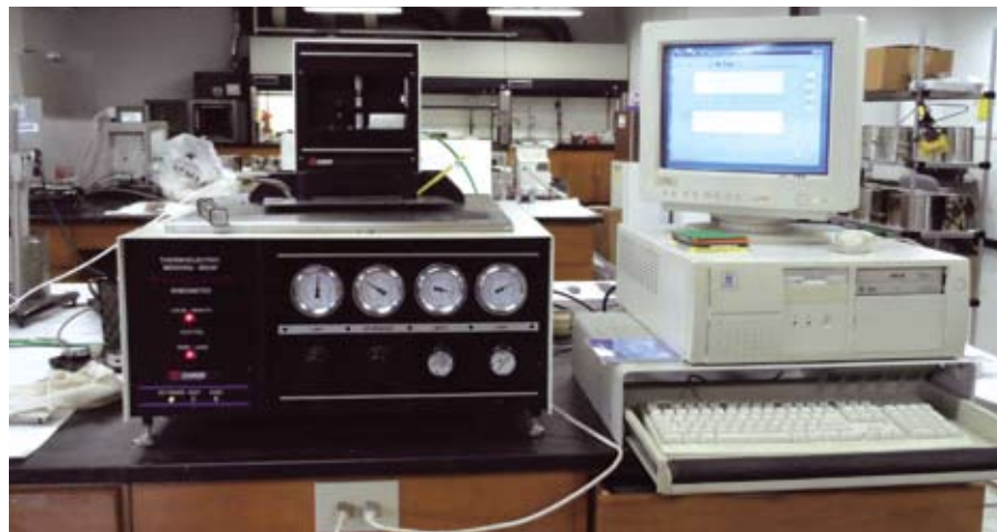
Рис. 4. Реометр с изгибающейся балочкой для испытаний по AASHTO T313
