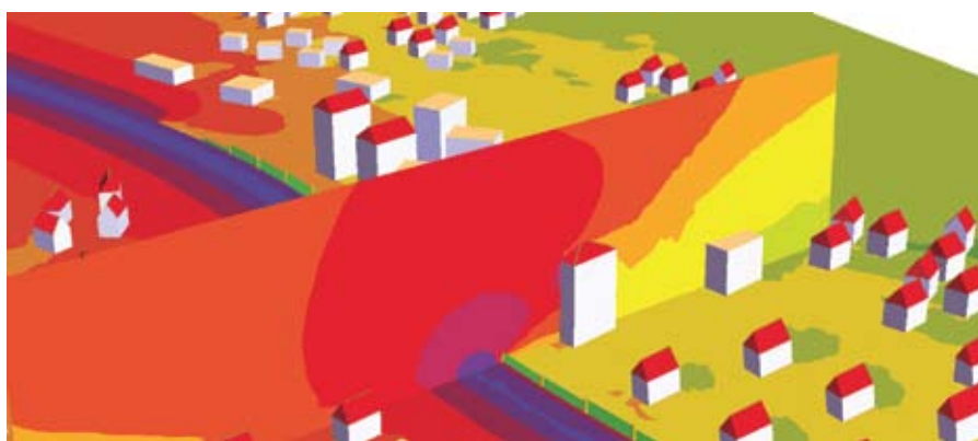
Результаты трехмерного моделирования акустической нагрузки с использованием программного комплекса SoundPLAN
