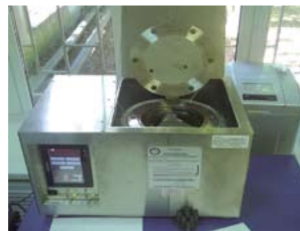
Рис. 1. Печь для старения образцов под давлением
