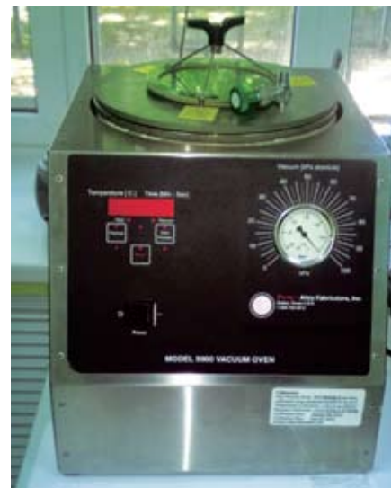
Рис. 2. Вакуумная печь для дегазации образцов
