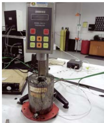
Рис. 6. Ротационный вискозиметр для определения динамической вязкости
