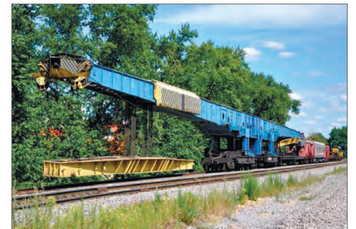
Специальный кран ГЭПК-130 для монтажа сборных балок пролетами до 33 м на ж.-д. мостах
