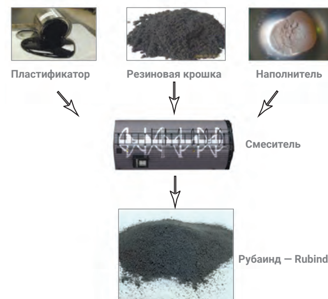
Рис. 2. Физико-химический процесс «Рубаинд» активации резиновой крошки
