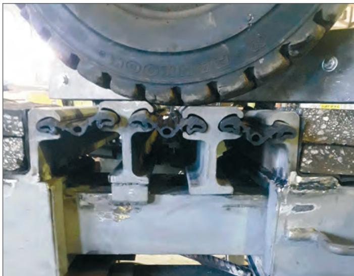
**Фото 5. Проведение испытаний деформационных швов СК-240**
