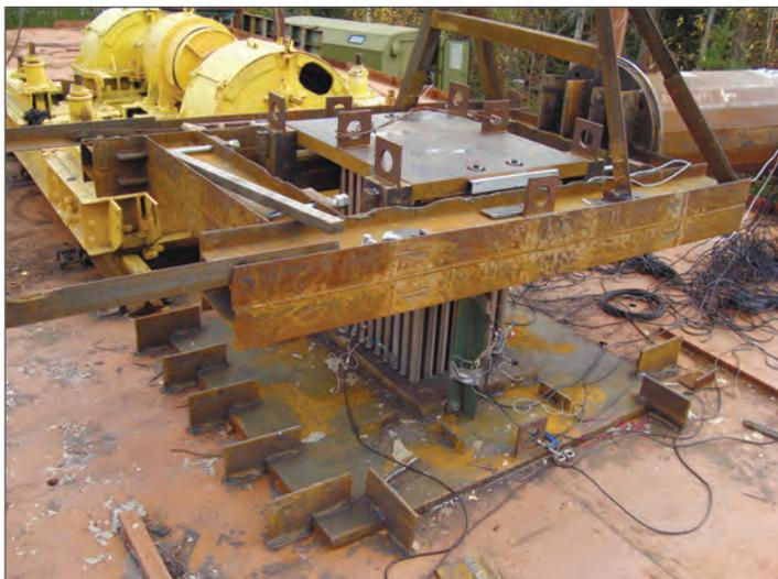
**Испытания стержневого амортизатора на сейсмоплатформе**
