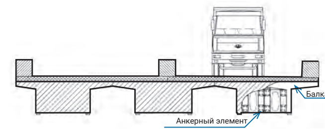
Рис. 1. Принципиальная схема метода — усиления пролетного строения мостового сооружения превращением его в коробчатое
