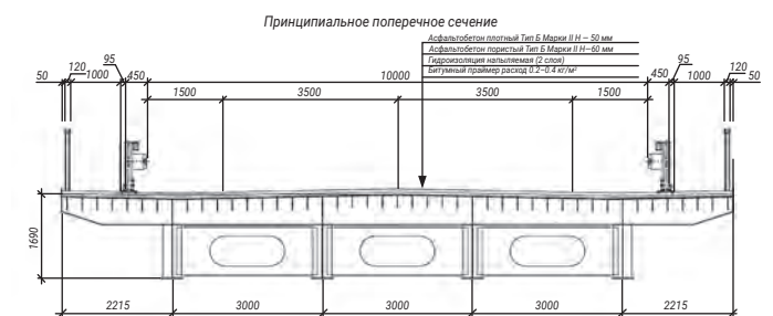
Рис. 14. Принципиальное решение блок-моста для малых и средних пролетов
