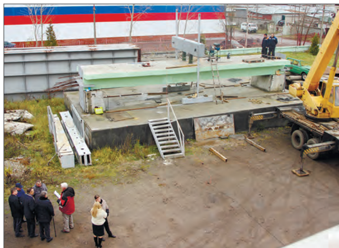
Фото 3. Натурный образец под статической нагрузкой 2
