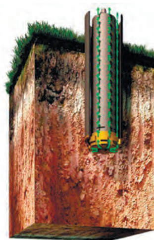
Рис. 1. Принцип работы пневмоударного метода
